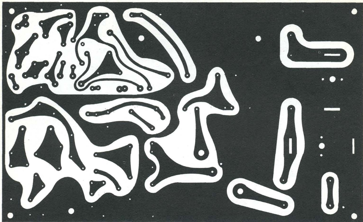
Traccia del circuito stampato vista dal lato rame. La basetta stampata può essere richiesta alla segreteria del laboratorio di Radio Elettronica dietro versamento di lire 500.
